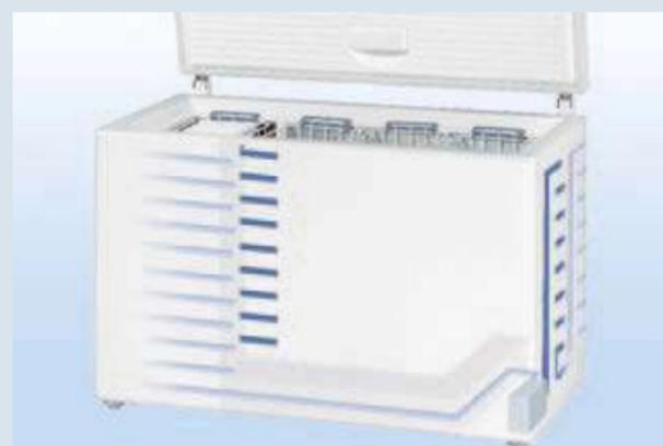
I congelatori orizzontali Liebherr hanno il condensatore inserito nelle pareti esterne: durante il funzionamento non si forma mai condensa. Anche l'**evaporatore è schiumato** in prossimità delle pareti interne: la temperatura uniforme all'interno del vano vi permetterà di congelare gli alimenti senza doverli riposizionare.
